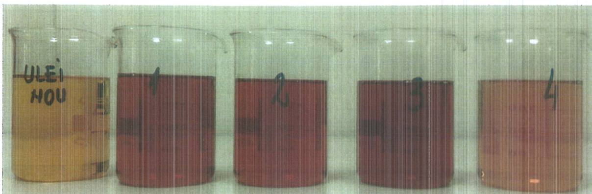
Fig.38 Mostre de ulei hidraulic Mobil DTE 25 nou si prelevate de la cele 4 turbosuflante
